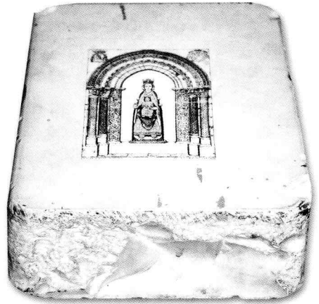
Piedra litográfica dibujada por Obdulio López de Uralde y usada por Fournier para sacar la tarjeta conmemorativa de la coronación de la Virgen de Estíbaliz en 1923.
